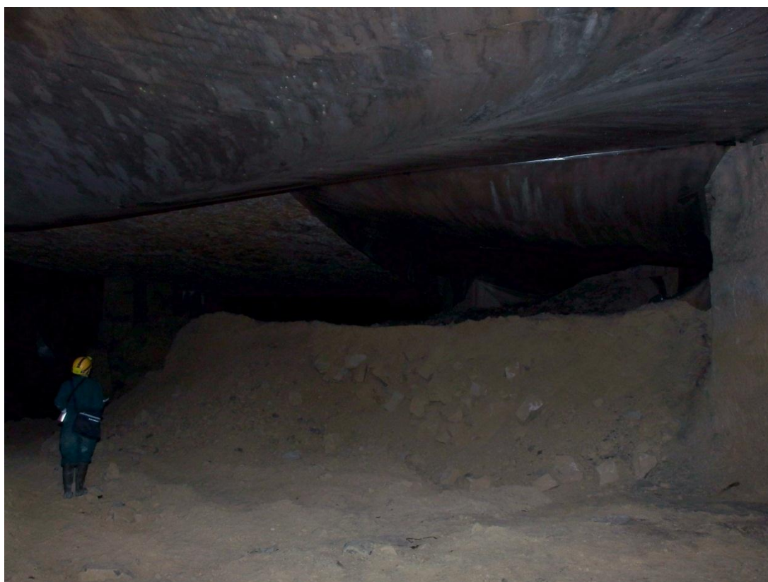
Illustration 21 - Zone de remblais poussés en partie centrale de la carrière de Pochiet (secteur nord)
