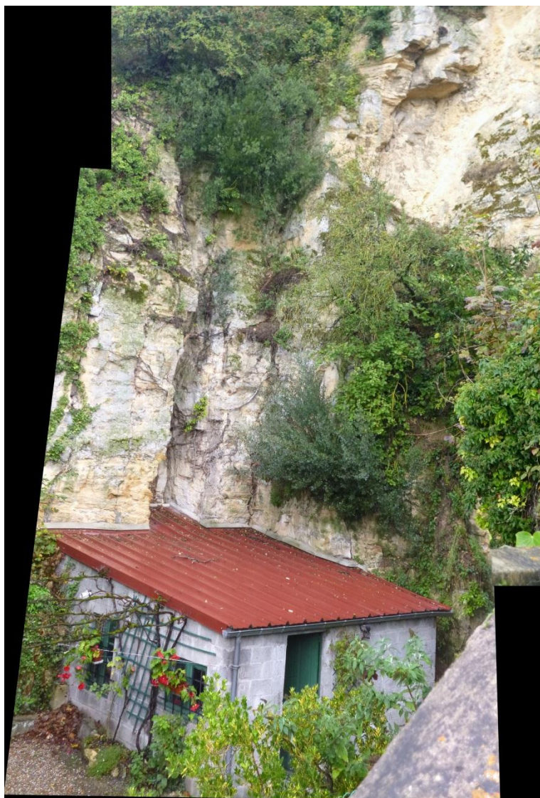
Illustration 27 – Bloc susceptible de se détacher en surplomb d'un appentis (au niveau du n°61)
