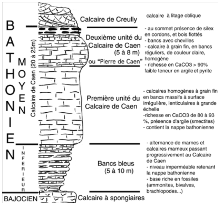
Illustration 6 - Coupe synthétique du calcaire de CAEN - Bathonien inférieur et moyen (d'après Rioult et Fily - Colloque du Jurassique 1997)
