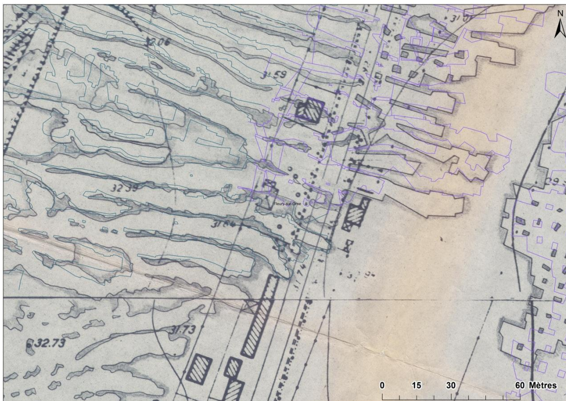
Illustration 8 – Secteur des carrières de Fleury-sur-Orne où les plans anciens sont concordants avec les levés de géomètres (représentés en couleur)
