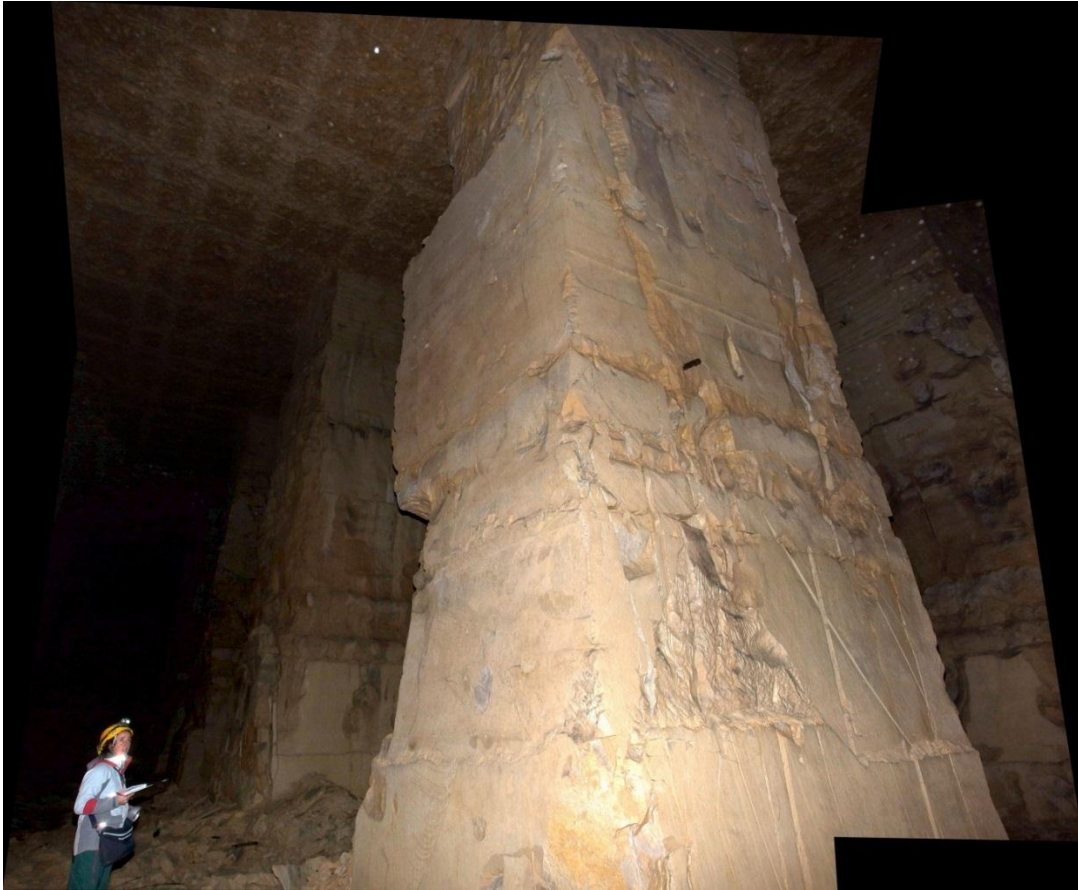
Illustration 24 – Ecaillage et fissuration d'un pilier dans la zone E de la carrière de Pochiet
