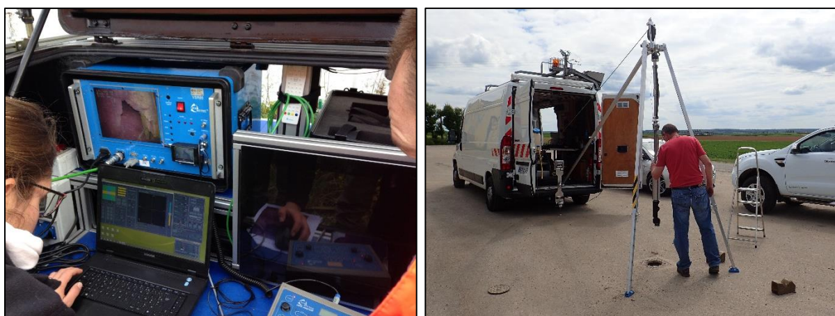
Illustration 44 : Inspection à partir de la surface avec la caméra vidéo-laser.
