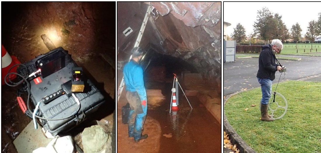
Illustration 52 : Cartographie 3D - Zeb-Revo - BPS - Opérateur avec récepteur en surface.
