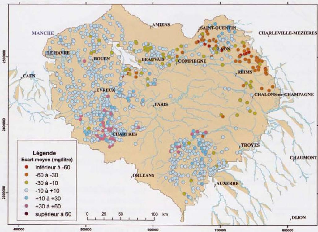
Figure 21 : Moyenne des écarts entre concentrations en nitrates observées et simulées en 2000 pour l'aquifère de la Craie.
