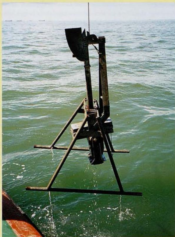
seur importante de sédiments contraint à l'utilisation d'un carottier lourd. Il s'agit d'un carottier gravitaire à piston stationnaire de type Kullenberg (photo ci-dessous). Ce matériel nous permet de collecter des carottes dans des chemises en PVC (10 cm de diamètre, longueur comprise entre 1 m et 2,5 m) analysées ensuite au laboratoire.
