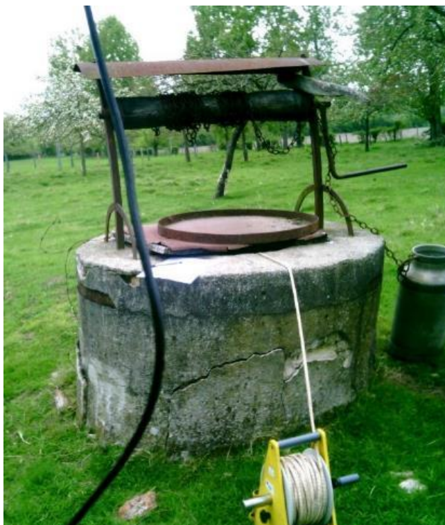
Illustration 141 : Exemple de mesure manuelle réalisée à l'aide d'une sonde à ruban (BRGM)
