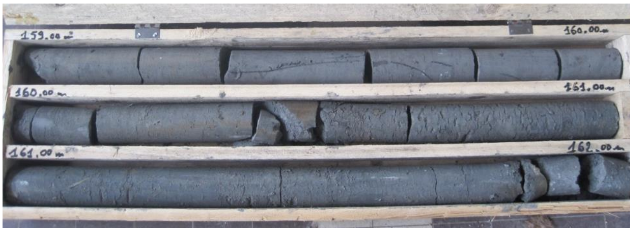
Illustration 19 : Faciès des Argiles du Gault de l'Albien supérieur rencontrés en fin de forage dans le sondage de la CODAH de Nointot (ici entre 159 m et 162 m de profondeur) – ouvrage BSS 00756X0209
