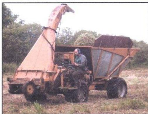
Engin spécialisé dans la coupe en zone humide et en lande permettant l'exportation des produits de fauche. Ce type d'engin est par exemple utilisé afin de constituer des pare-feux dans les landes armoricaines composées d'ajoncs.
