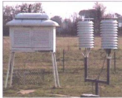
Actuellement, les stations de Météo-France sont équipées d'abris miniatures ou « modèle réduit » comme sur les photographies ci-dessous. Des grands abris de type Stevenson sont encore utilisés par certaines stations mais de façon plus restreinte.
