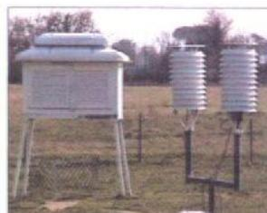
Actuellement, les stations de Météo-France sont équipées d'altes instrumentés de « modèle robot » comme sur les photographes ci-dessous. Des gauch altes de type Stevenson sont encore utilisés par certaines stations mais de façon plus restreinte.
