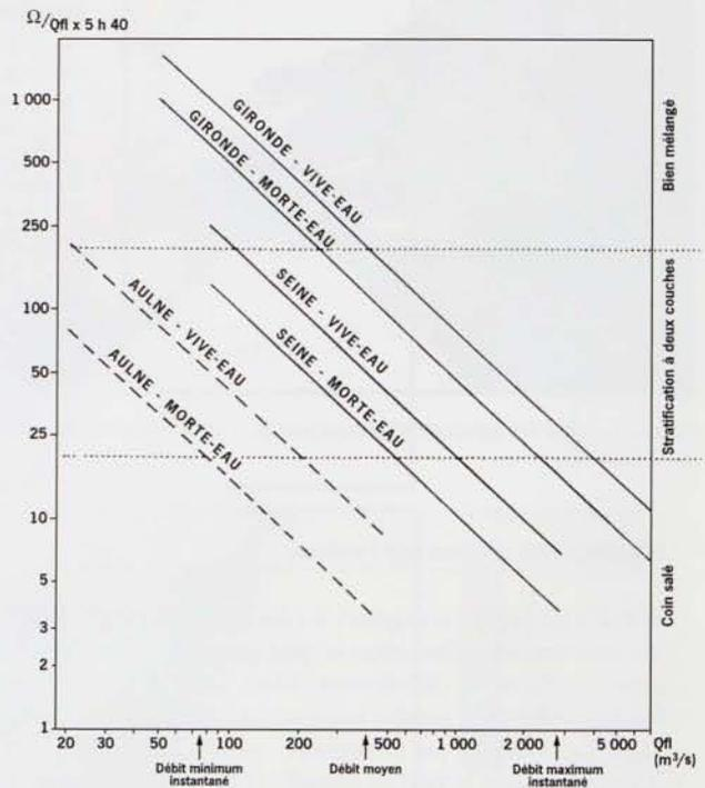
Figure 20 - Classement hydrologique de l'estuaire de la Seine (selon le rapport entre le volume oscillant  $\Omega$  et la quantité d'eau douce apportée par le fleuve) en fonction du débit fluvial (Avoine, 1981).
