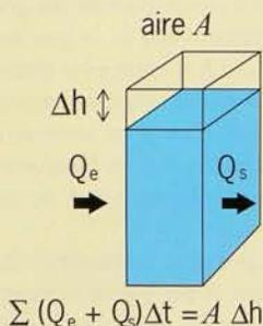
Le modèle est « piloté » par des conditions imposées aux limites (par exemple, le niveau de l'eau qui varie avec les marées ou le débit des rivières ou encore le frottement exercé par le vent en surface), et contrôlé par les informations sur la position du fond (bathymétrie) et sa rugosité (qui intervient sur le frottement).
