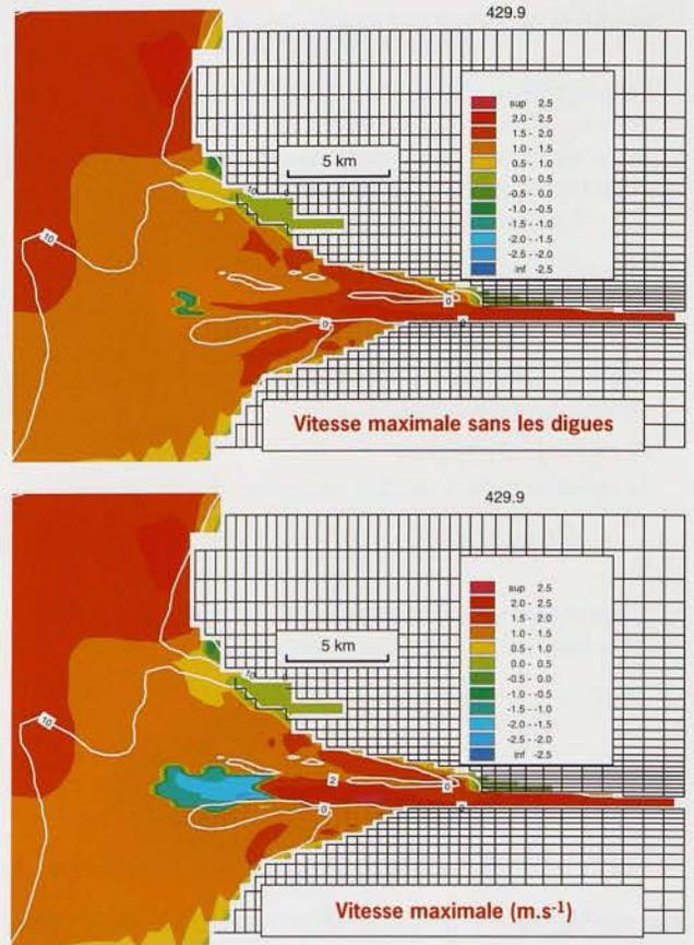
Figure 29 - Simulation de l'effet de la suppression des digues submersibles sur la distribution des courants maximums dans l'estuaire de la Seine. Vert/bleu : vitesses maximums en jusant ; Jaune/rouge : vitesses maximums en flot.
