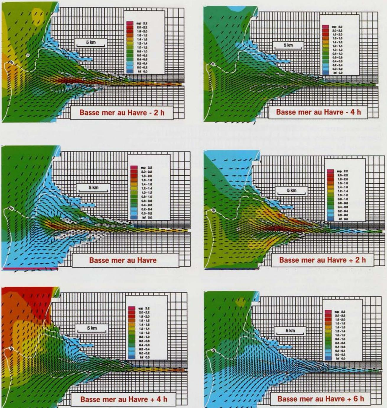
Figure 2 - Distribution des courants de marée (en  $m.s^{-1}$ ) à l'embouchure de la Seine en vive-eau. Simulation par le modèle SAM-3D de la marée du 17 octobre 1997 (coefficient 114). Les flèches ont toutes la même longueur et indiquent la direction du courant. Les vitesses sont représentées par les gammes de couleur.
