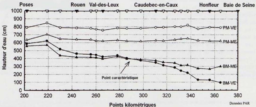
Figure 9 - Niveaux de pleine mer et de basse mer en vives-eaux (○-○ pleine mer, ●-● basse mer) et en mortes-eaux (△-△ pleine mer, ▲-▲ basse mer) dans l'estuaire de la Seine pour un débit d'étiage (coefficients 113 et 46, respectivement, pour un débit du fleuve au barrage de Poses de  $300 \text{ m}^3 \cdot \text{s}^{-1}$ ) (d'après Guézennec, 1999).
