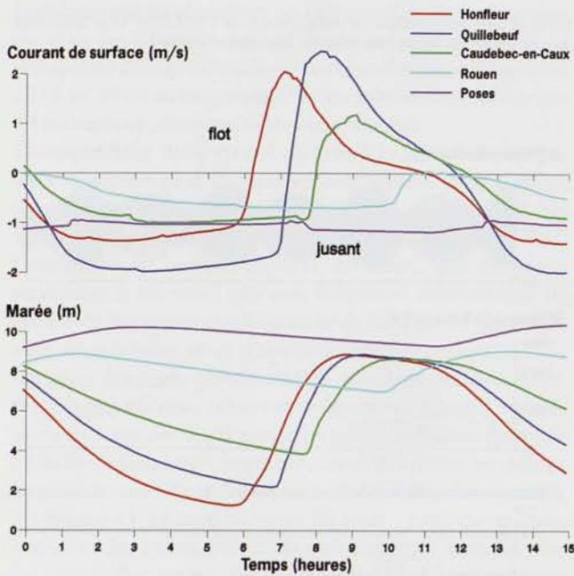
Figure 8 - Évolution des vitesses et de la surface libre en plusieurs points de l'estuaire au cours d'une marée de vive-eau (coefficient 114). Débit de crue (environ  $1000 \text{ m}^3 \cdot \text{s}^{-1}$ ). Simulation par modèle.
