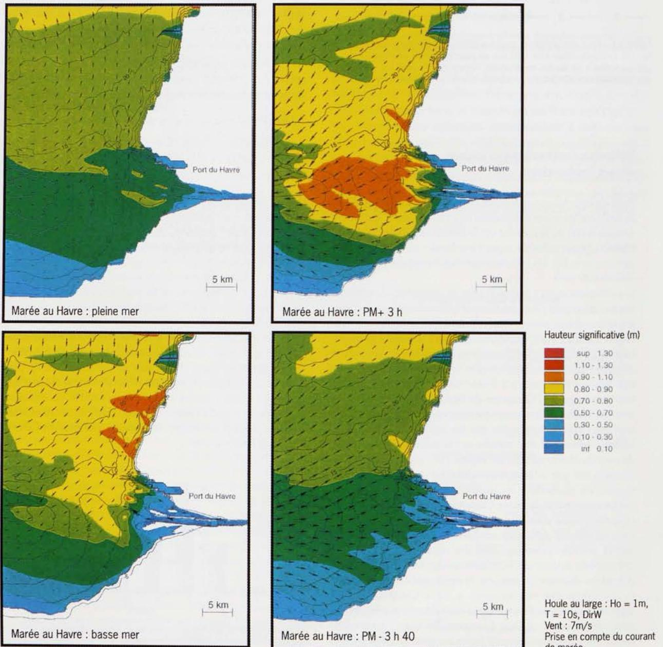
Figure 18 - Calcul des agitations en baie de Seine orientale, pour différentes phases d'une marée de vive-eau. Les flèches représentent le courant de marée.
