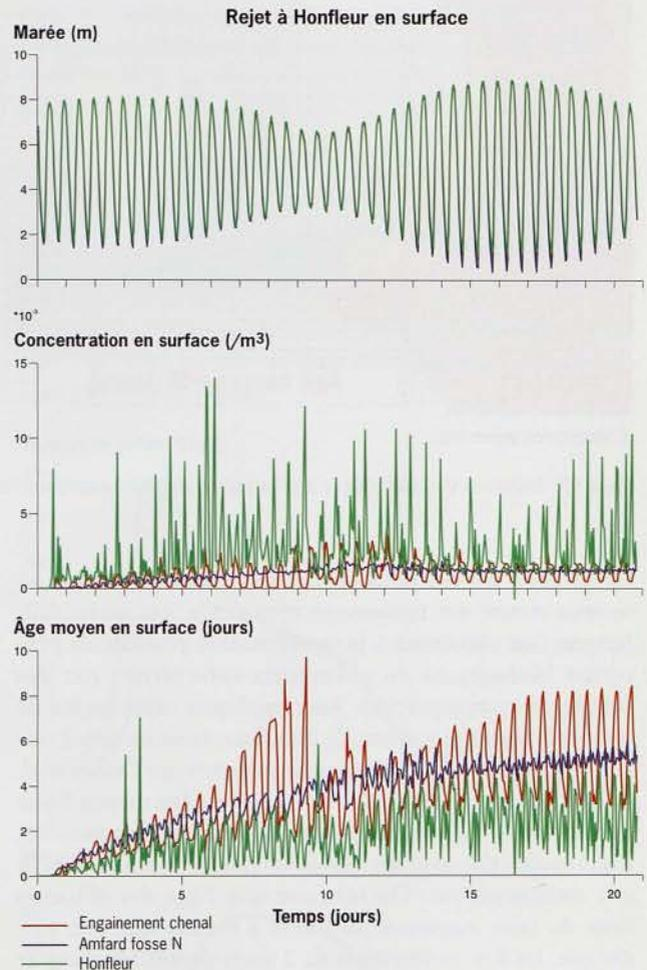
Figure 26 - Simulation d'un rejet unitaire (= 1 s<sup>-1</sup>) continu à Honfleur. Évolution de la concentration (par mètre cube) et de l'âge de l'effluent en quelques points (Honfleur; dans la « fosse Nord », à Amfard; dans le chenal, au niveau de « l'engainement »), simultanément à la marée.
