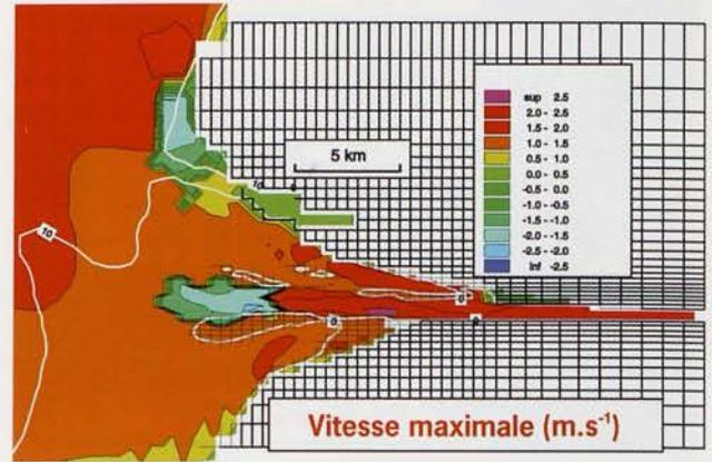
Figure 3 - Distribution des courants maximaux de surface au cours d'une marée de vive-eau (simulation du 18 octobre 1997, coefficient 110). Les valeurs sont négatives (respectivement positives) lorsque le maximum est obtenu en jusant (respectivement en flot).
