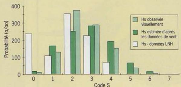
Comparaison entre les histogrammes de la hauteur significative (Hs) des vagues, (1) mesurée par houlographe (LNH), (2) estimée d'après les données de vent ou (3) observée depuis le sémaphore de la Hève, et exprimée selon le code S des états de la mer (voir fig. 15).
