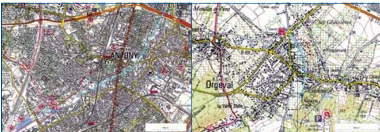
↑ **Figure 16** : Exemples de couverture de cours d'eau. A gauche, la Bièvre (couverte sur plus de 10 km) et à droite l'Orgeval (couvert sur 900 m). En pointillés bleus le tracé souterrain probable (source : Géoportail, IGN).
