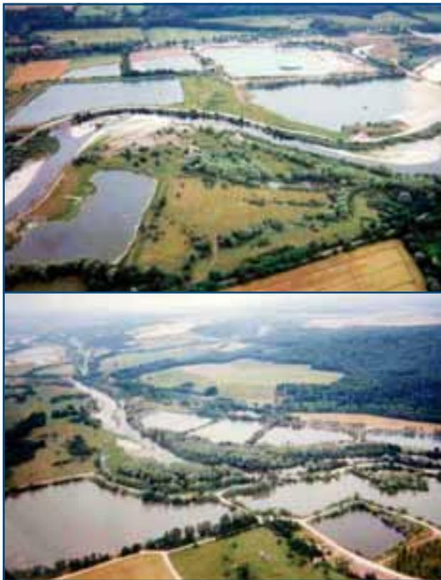
Figure 39 : Exemple de mitage du lit majeur par les exploitations de granulats, qui grèvent de manière irréversible les possibilités de recharge alluviale par érosion latérale. La mise en œuvre du concept d'espace de mobilité est impossible (la Moselle). ≡
