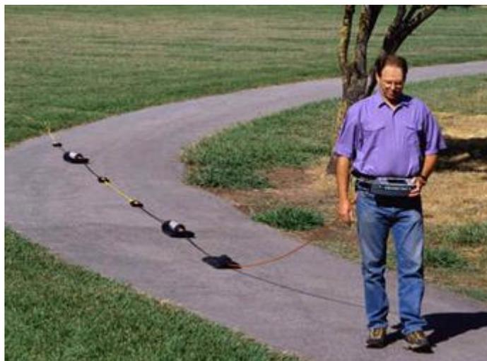
*Illustration 28 : Dispositif OhmMapper (source : Geometrics)*
