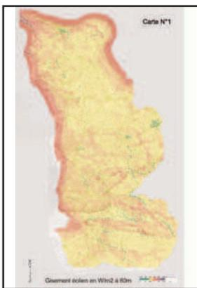
La carte n°1 du gisement éolien précise, par classe, la vitesse moyenne des vents et la densité de puissance disponible à 60 mètres au-dessus du sol.
