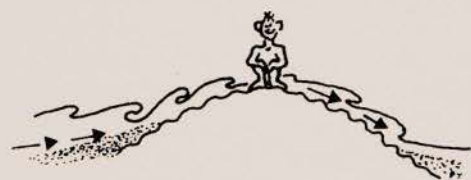
Epi à profil arrondi et rugueux : ENERGIE ABSORBEE PROGRESSIVEMENT
