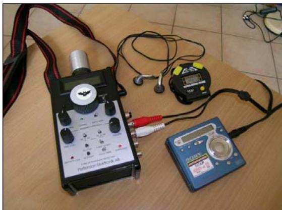
**Figure 2 :** Détecteur d'ultrasons Pettersson D980 et lecteur/enregistreur MD Sony utilisés pour l'écoute et l'identification des chauves-souris.
