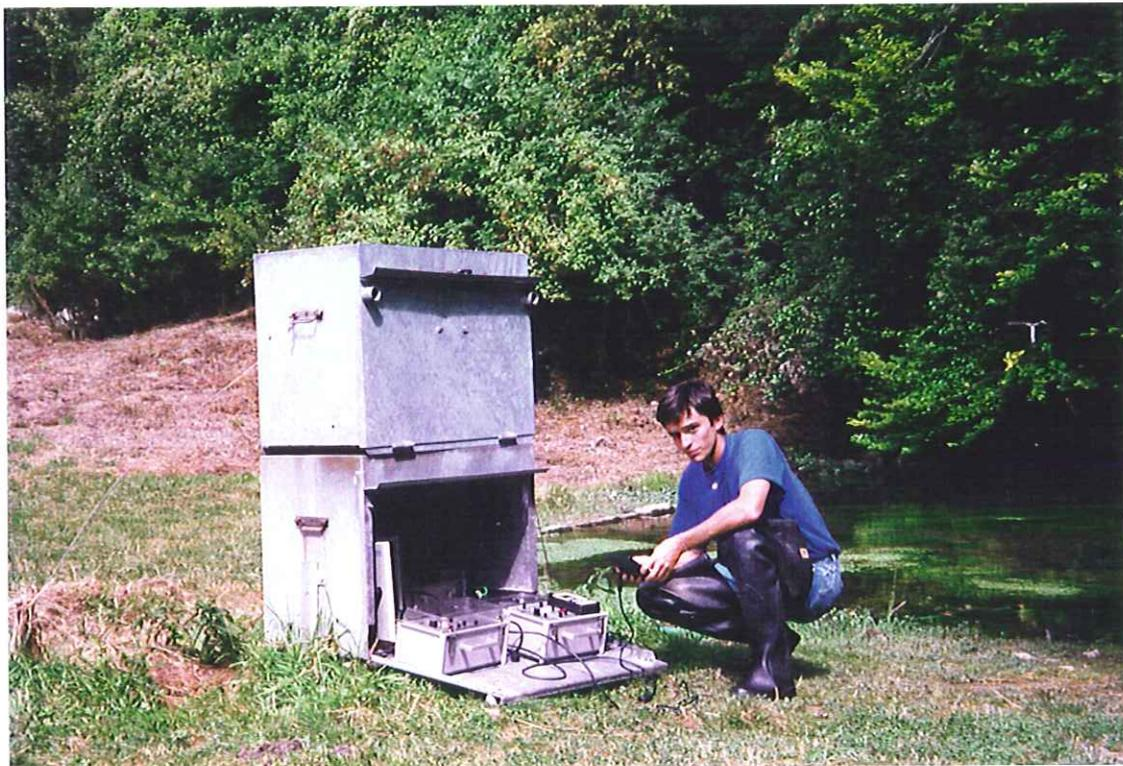
Photo n°3: récolte des données du conductimètre et turbidimètre de terrain, stockées dans la centrale d'acquisition
