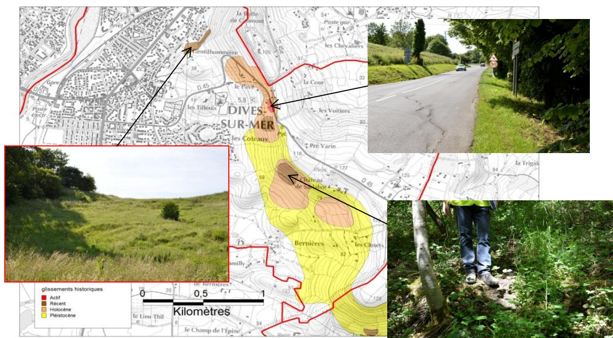
Illustration 9 : Exemples d'indices de terrain associées à des phénomènes de glissement de terrain récent. Commune de Dives-sur-Mer
